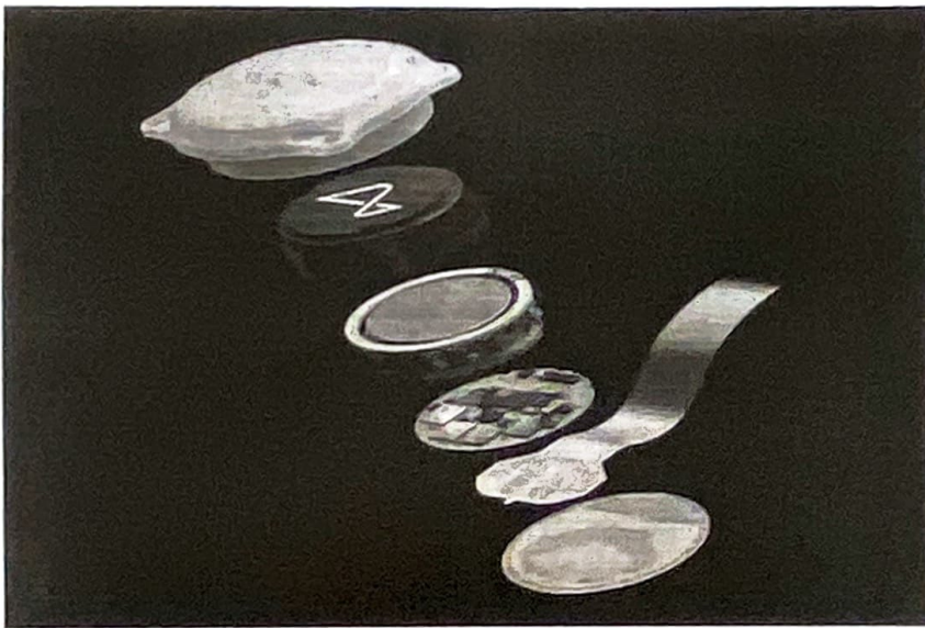
A empresa recebeu no ano de 2023 o aval do governo dos Estados Unidos para iniciar os testes em seres humanos e já iniciou o recrutamento de participantes para o estudo. O chip (Interface Cérebro-Computador) é uma pequena sonda contendo mais de 3 mil eletrodos ligados a fios flexíveis mais finos que um fio de cabelo humano 14 .
